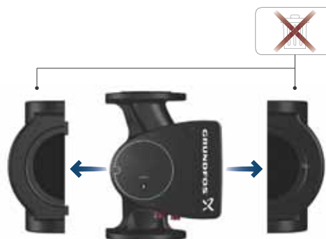
Obr. 8 Demontáž tepelně-izolačních krytů z čerpadla
